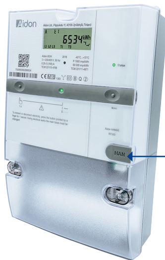
Kuva 1: Integroitu HAN- rajapinta Aidonin energia-palvelulaitteessa.
